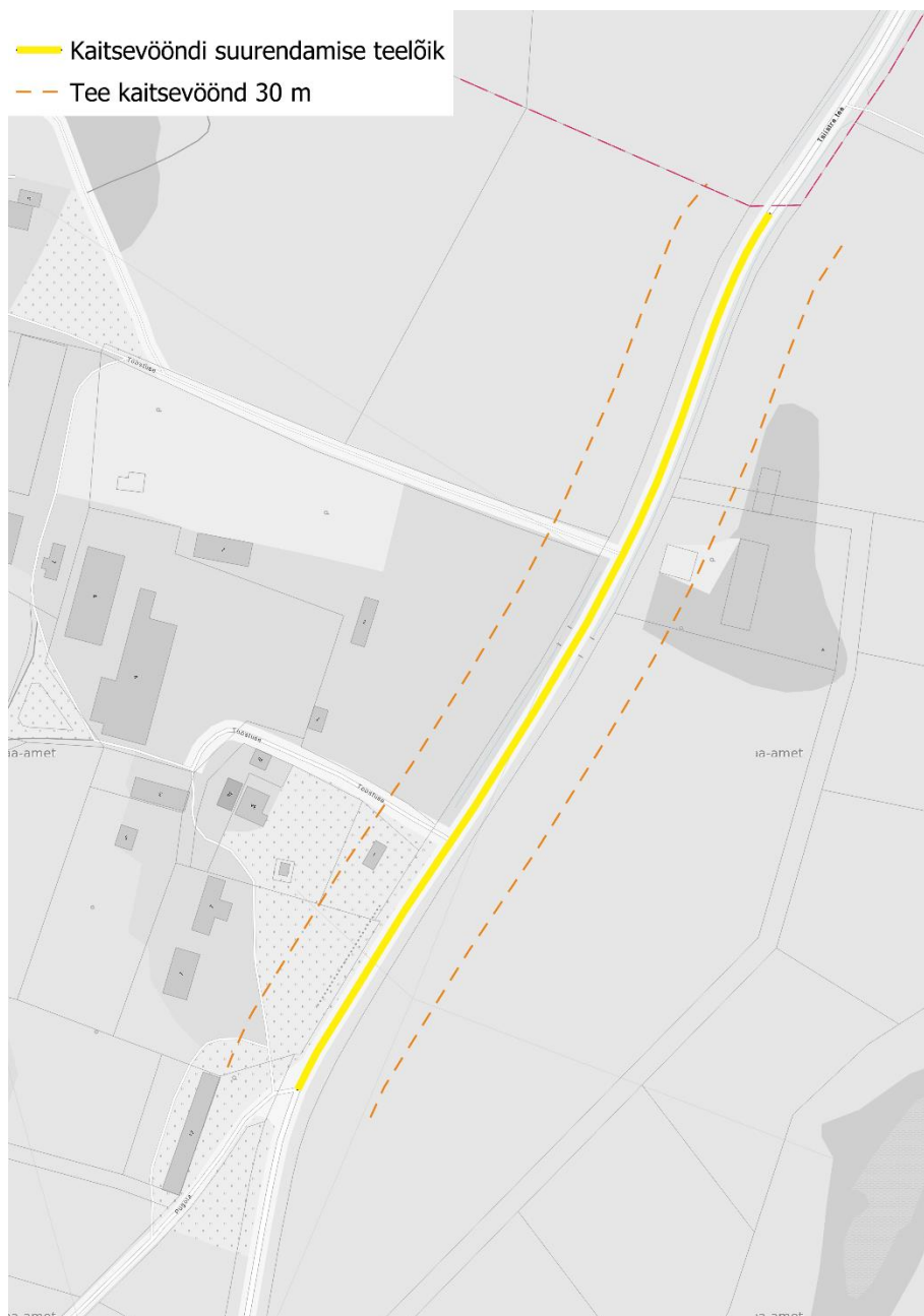
Skeem 8. Tee kaitsevööndi suurendamine Misso alevikus riigiteel nr 25177 Pugola tee ristist kuni aleviku piirini.
